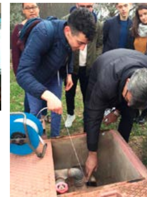
Sergi midiendo el nivel freático en el sondeo que abastece de agua de riego a los jardines del Campus previa desalación.
